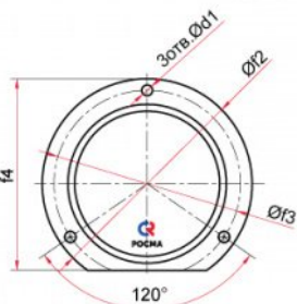
Осевое присоединение байонетное кольцо (Ø63 мм)
